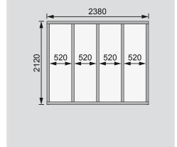
Fundamentplan mit Boden (in mm)
